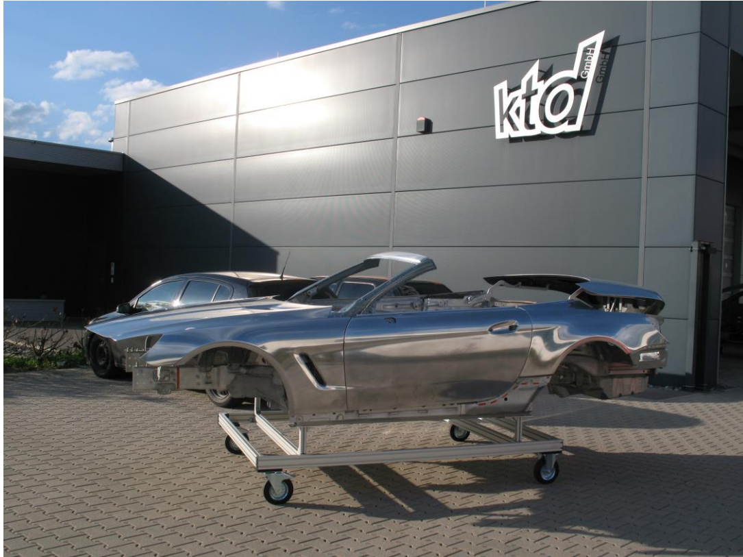
Ausstellungsfahrzeug: Voll-Aluminiumkarosserie auf Hochglanz poliert
