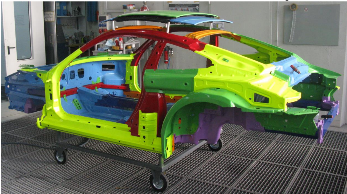
Ausstellungsfahrzeug: Multimaterialmix-Karosserie, Werkstoffdarstellungen
